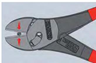
Vkládejte dráty vždy co nejbliže ke kloubu. U kleští se silným převodem je otvor u středu otáčení většinou menší než tloušťka drátu a dráty tak při nastříhnutí mohou sklouzavat dopředu
