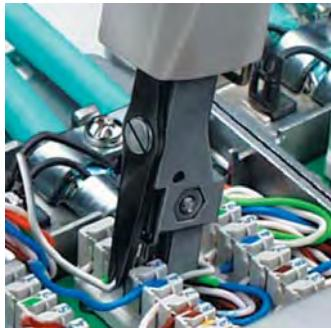
Vtlačení a ustřízení kabelu v jedné
