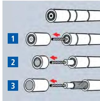
Třístupeňové odizolování koaxiálního kabelu
