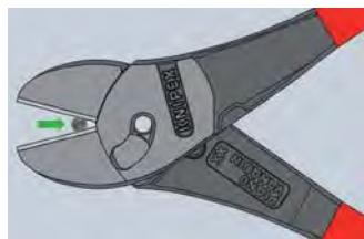
Vytvořte kleštěmi KNIPEX TwinForce® do drátu nejprve zářez, dokud silné nevzroste potřebná ruční síla. Nyní kleště otevřete a posuňte přitom drát v zářezu dále ke kloubu.
