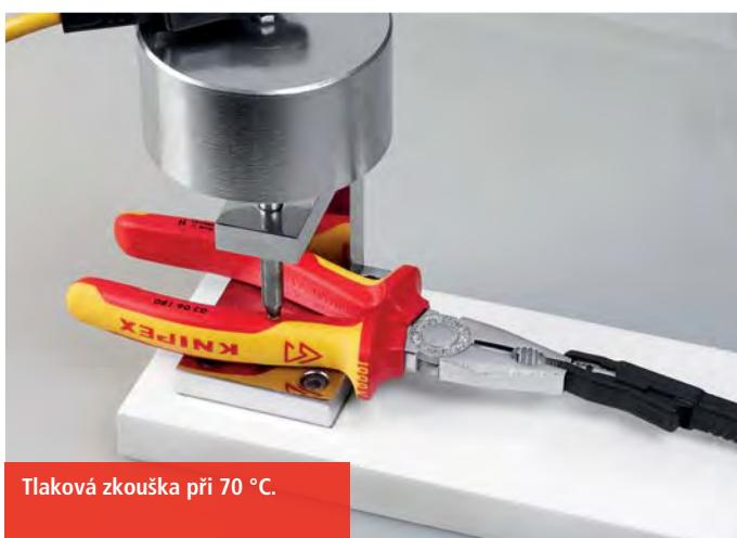
Tlaková zkouška při 70 °C.
