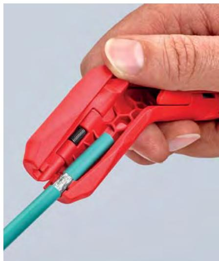
Odizolování datového kabelu
