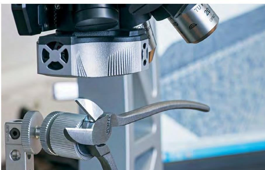
U bočních štípacích kleští se přesně proměnuje tvar a drsnost břitů optickým 3D měřicím systémem.
