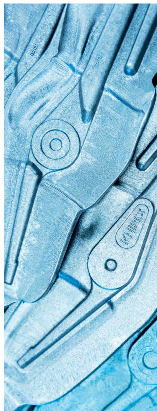
Rameno „kleští na vodní čerpadla Alligator®“ při kování pod hydraulickým kladivem.
