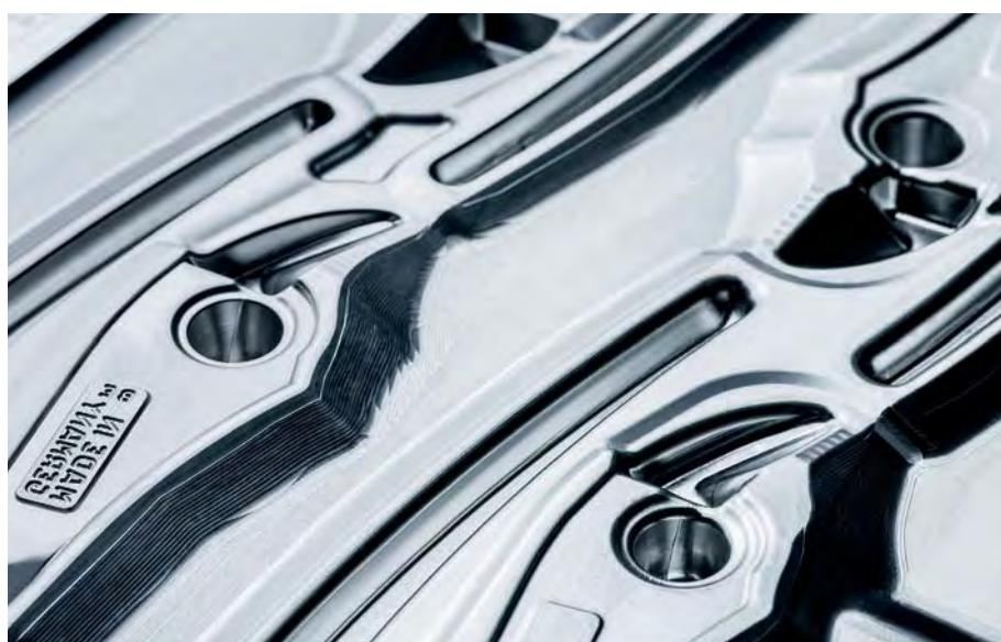
Kovací záplustka pro silové boční štípací kleště s kovaným kloubem.
