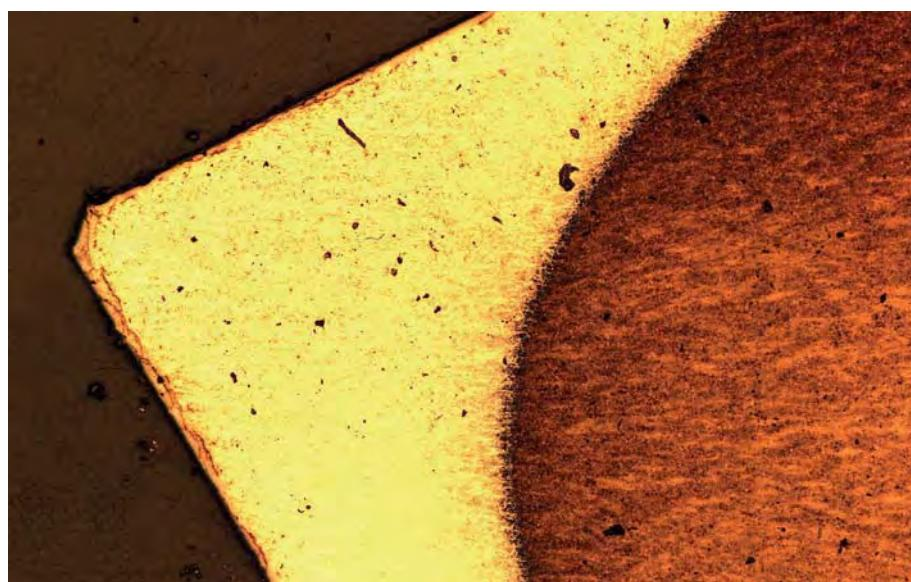
Makrofotografie břitu po indukčním kalení. Přesně se oddělí speciálně kalená oblast břitu (světlá) od měkčí struktury tělesa kleští (tmavá).
