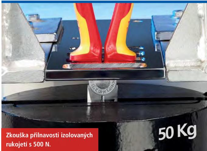
Zkouška přílnavosti izolovaných rukojetí s 500 N.
