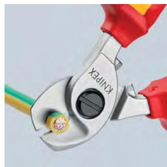
Přestřízení kabelu kleštěmi na kabely:
