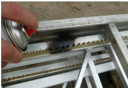
WS 468 je ideálny pre mazanie ozubených kolies, ozubených prevodoviek, reťazi a tāčných lán. Tlmí zvuk, zaistuje hladký chod a chráni pred opotrebovaním a koróziou. Vytvára suché lepidlo, tlak-odolný, ochranný a mazací film. Je viskózny a vodotesný. Nie je krehký pri nízkych teplotách. Tepelne odolný pevný mazací film až do cca. 300 ° C.
