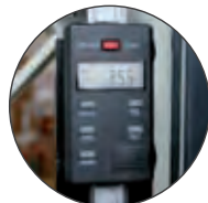
Digitálne zobrazenie výšky materiálu
