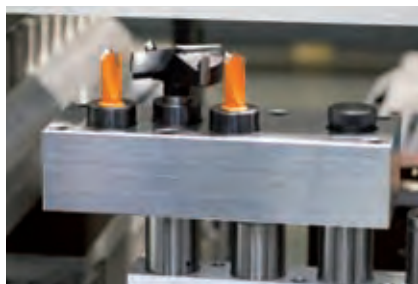
Použitie vrtacej hlavy v kolíkovачke.
